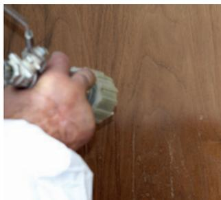
Feuchtigkeit ist Gift für Möbel mit aufgeleimtem Furnierblatt, da sie verleimte Stellen löst. Zur Behandlung solcher Stücke verfügen wir über eine Strahlkabine. Darin entfernt unser Fachpersonal den Lack besonders sanft, indem es die Möbelstücke unter Verwendung von Glasmehl oder Backpulver strahlt. Leider sind aber nicht alle Lacke zum Strahlen geeignet.
