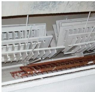
In einem speziellen Verfahren werden die Holzfasern der Fensterläden abgesengt, die Oberflächen mit Glasmehl entfasert und anschliessend manuell nachgeschliffen. Zur Gewährleistung des Wertehalts behandeln wir die Beschläge mit Eisenrostschutz und schützen das Holz durch Imprägnierung und Trommelgrundierung. Optional bieten wir einen Zwischenschliff mit einer zweiten Trommelgrundierung an.
