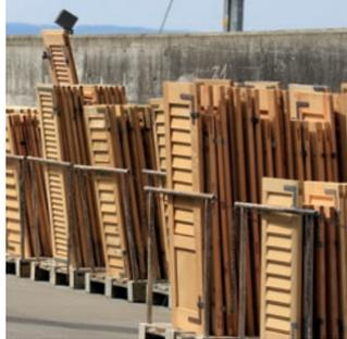
Zur detaillierten Auftragserfassung messen wir jeden Fensterladen nach dem Eintreffen aus. Für eine schonende Ablaugung und Neutralisierung des Holzes durchläuft jeder Fensterladen unseren industriellen 5-Zonen-Ablaugeautomaten. Die so abgelaugten Läden werden anschliessend in einem geheizten Raum unter Berücksichtigung eines konstanten Klimas während drei Tagen getrocknet.
