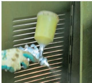
Nach sorgfältiger Trocknung wird die Carrosserie bzw. das Fahrzeugteil optional mit einer zuschlagpflichtigen Langzeitrostschutzgrundierung behandelt und bei optimaler Temperatur getrocknet. Sie bietet einen perfekten Schutz während der gesamten Restaurationszeit. Sogar Schweißarbeiten sind möglich, ohne die Schutzschicht zu entfernen. Wir sind über die Landesgrenzen hinaus dafür bekannt, beste Voraussetzungen für eine erfolgreiche Restauration zu schaffen. Darauf sind wir stolz!
