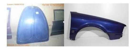
Motorhauben, Heckdeckel und Kotflügel, welche einwandig sind, werden innen und aussen gemessen.
