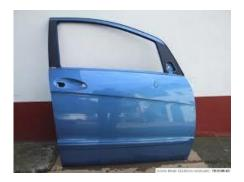
Bei doppelwandigen Fahrzeugtüren, bestehend aus Innen- und Aussenblech, d.h. 4 Blechseiten, werden wegen der Fensteröffnung nur 3 Seiten berechnet.
