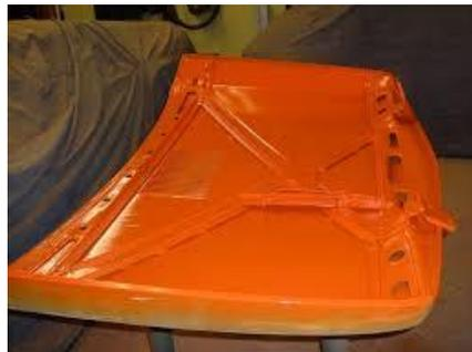
Bei Motorhauben und Heckdeckel mit Verstrebungen und Verstärkungen (mehr Material).
