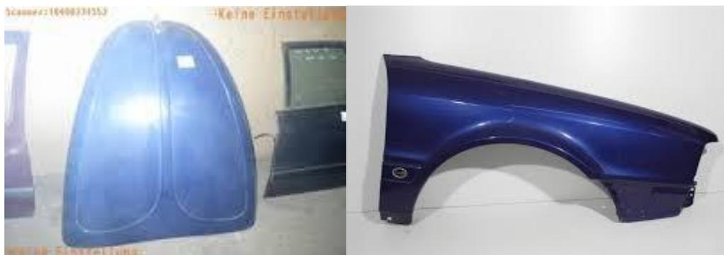
Motorhauben, Heckdeckel und Kotflügel, welche einwandig sind, werden innen und aussen gemessen.
