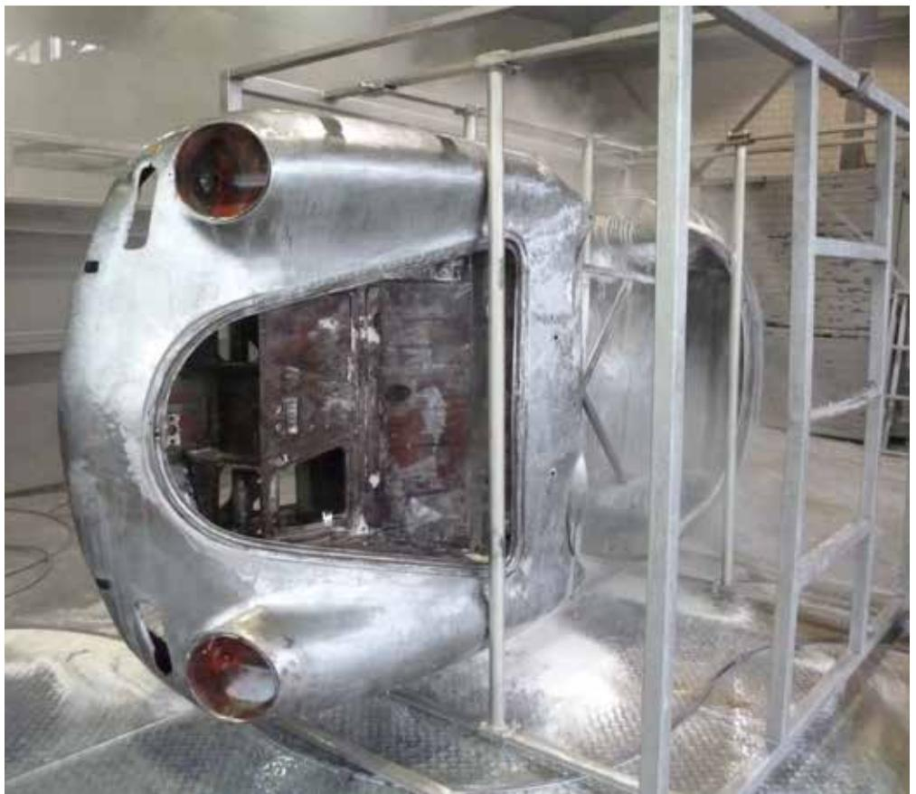
diesem auf dem weiteren Transportweg nichts passiert, kommt eine Eisenphosphatierung drauf. Die kann für die Grundierung belassen werden. Dann werden Karosserie und alle separaten Teile luftgetrocknet und sorgfältig verpackt dem Kunden
